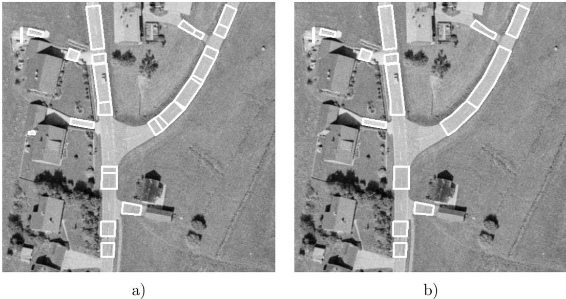
**Fig. 8:** a) Road-parts b) Road-segments
